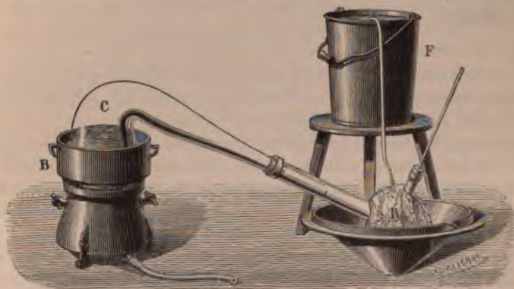
Fig. 60. — Préparation du brome dans les laboratoires.
